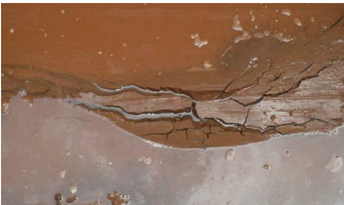
Hydraulischer Grundbruch in einem bindigen Boden; Foto: Ing. Büro LOGIC
