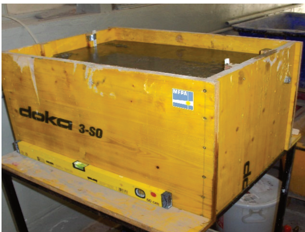
Mit RSS Flüssigboden gefüllter Prüfbehälter [1]
