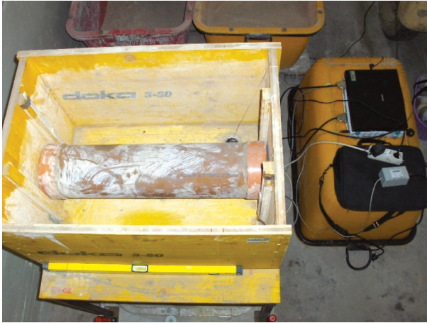
Rohr, seitlich geführt in einer Versuchsanordnung [1]
