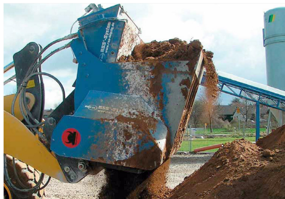
Die neuen Schaufelsepa- ratoren lassen sich flexibel und wirtschaftlich einsetzen. Foto: PROV
