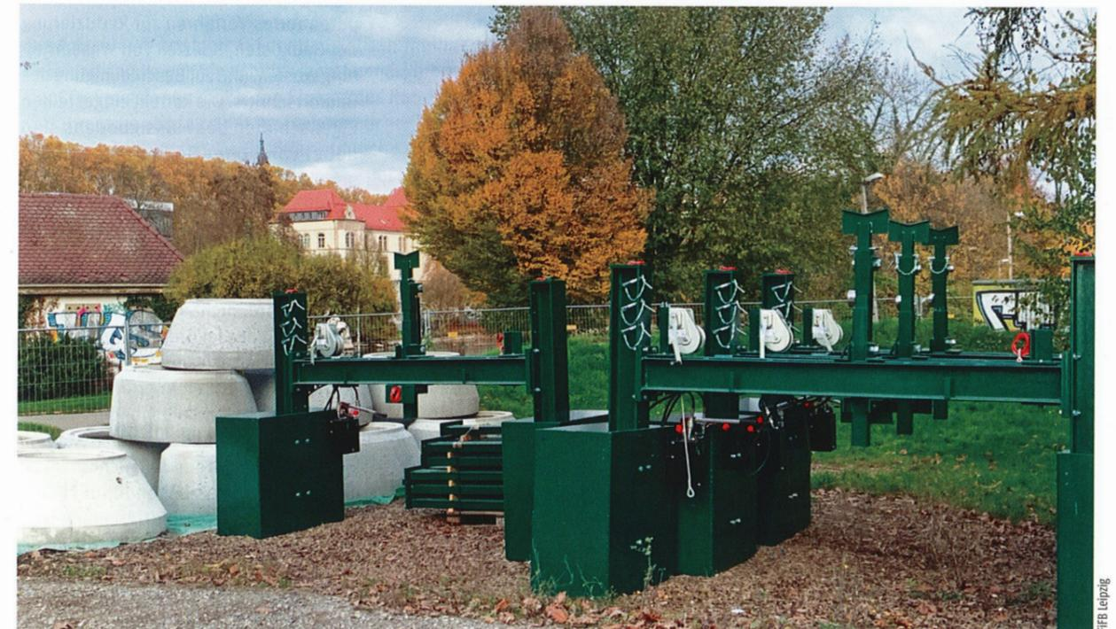
Abb. 2 – RSS-Rohrverlegehilfen auf dem Mischplatz in Tübingen; die Rohre schwimmen bei Einsatz im frisch eingebetteten Flüssigboden nicht auf.
